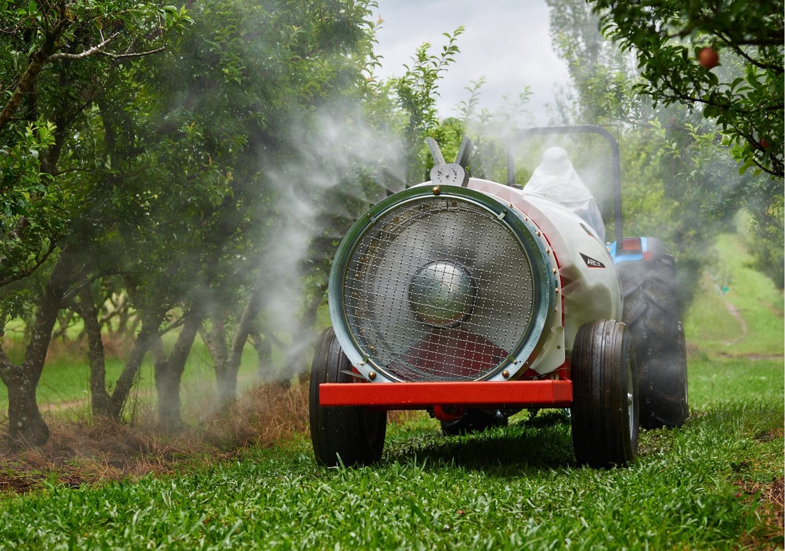
**PULVERIZADOR REBOCADO - TURBINA**
